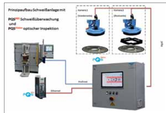
Systemaufbau optische Qualitätskontrolle mit PQS vision
