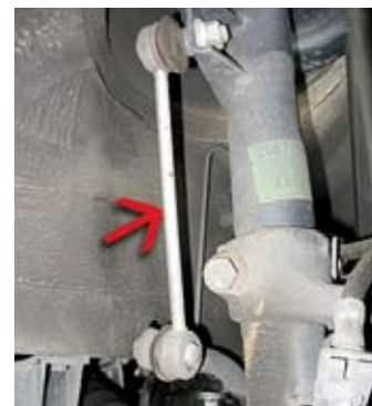
Schweißteil Koppelstange
