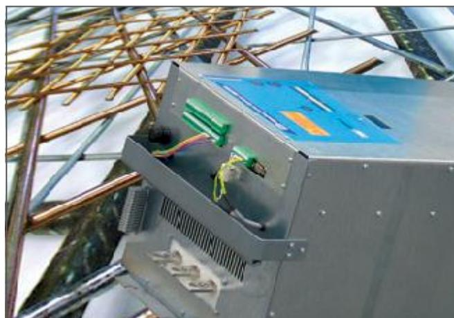
Bei einer Hochstromanwendung zum Schweißen von Gitterrosten werden an einer neu installierten Anlage Schweißströme von maximal 320 kA erreicht. Für den Serienbetrieb wird die Maschine mit 265 kA gefahren. Die vom Anwender selbst projektierte, konstruierte und aufgebaute Portalanlage wird von vier Invertern HWI2545 in Master-Slave-Schaltung mit dem nötigen Primärstrom versorgt. Im Portal sind die gewaltigen Mittelfrequenz-Schweißtransformatoren von viermal 700 kVA eingebaut.
