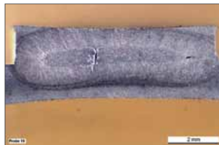
*Schweißpunkt in Aluminiumlegierung mit Rissen und Poren
