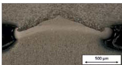
Schliffbild einer stoffschlüssigen Fügeverbindung
