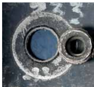
Abb. 2: Ausgeknöpfte Schweißung 1,9 mm 22MnB5+AS150 Blech mit M8 Ringbuckel-Schweißmutter
