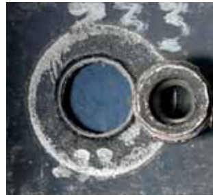
Abb. 2: Ausgeknöpfte Schweißung 1,9 mm 22MnB5+AS150 Blech mit M8 Ringbuckel-Schweißmutter
