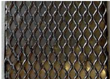
Abbildung 2: Material-Dummy poröse Transportschicht (PTL): Streckmetall auf Sinterkörper
