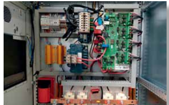
Aufbau Leistungsmodul der KAPKON GmbH
