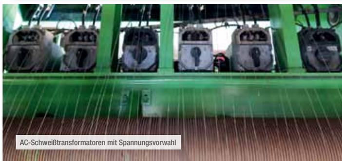
AC-Schweißtransformatoren mit Spannungsvorwahl
