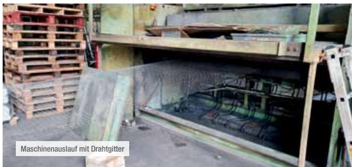
Maschinenauslauf mit Drahtgitter
